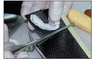
20) Sovrapporre 7/8/9 o più strati, cambiando di 2 o 3 gradi la direzione, aumentando così la multi-direzionalità delle fibre.
