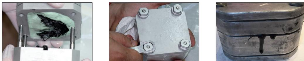
28) Cuocere per due ore a 80 gradi, ponendo della stagnola per evitare la colatura della bioresina e sporcare la camera del forno.
