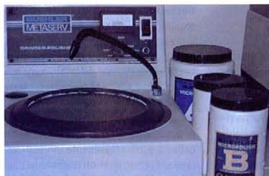
Fig. 10: lucidatrice a polveri di allumina.
