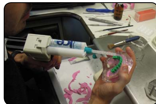
Uno dei primi passaggi relativi alla "messa in muffola", nel dettaglio la parte trasparente posta sotto il manufatto.
